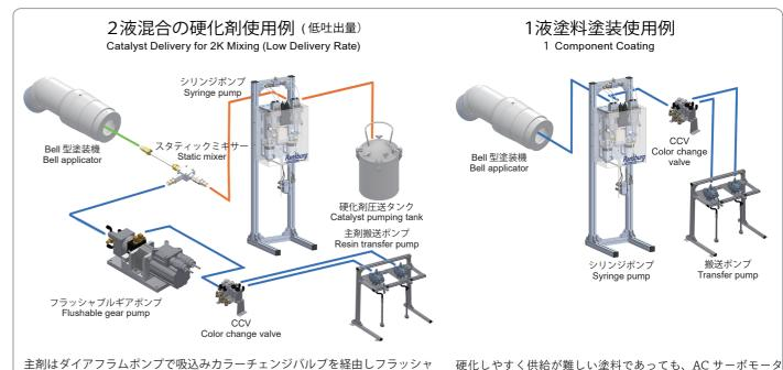
主剤はダイアフラムポンプで吸込みカラーチェンジバルブを経由しフラッシャブルギアポンプでスタテックミキサーに供給。一方、少量の硬化剤はシリンジポンプで高い精度でスタティックミキサーに供給。安定した2液混合塗装を実現します。
